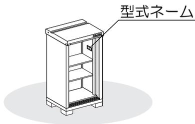
部品箱内の「型式ネーム」シールを側板右上部内側に貼り付けます。
