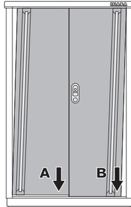
※3mm以上のスキマや上記の要領で調整できない時は、目隠しキャップをはずしベースの水平を出し直してください。(「2.ベース設置」を参照)
