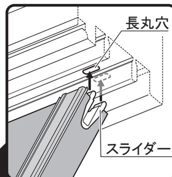
スライダーの先をアルミレールに空いている長丸穴に差し込み扉を取り付けてください。
